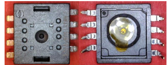
Das Herzstück der Maus: Optischer Sensor, Prozessor und USB Schnittstelle
