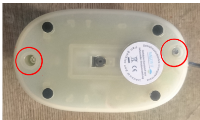
Hier befinden sich die Schrauben zum Lösen des Gehäuses
