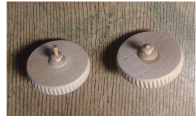
Ganzes und gebrochenes Scrollrad im Vergleich
