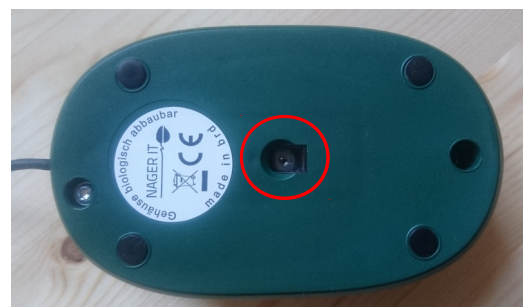
LED leuchtet nicht → sie ist vermutlich defekt
