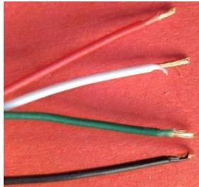
**7. Die Isolation der farbigen Adern an den Enden vorsichtig maximal 3mm entfernen**
