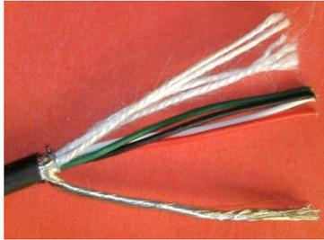
**5. Die Füllfäden mit einem Messer oder Seitenschneider abschneiden**
